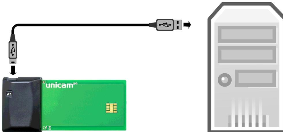
1.) Schließen Sie das Mini-USB-Kabel an den Programmer an. Stecken Sie das andere Ende an einen freien USB-Port Ihres Computers an. Es erscheint der Hardwaredialog für neue Hardware:
